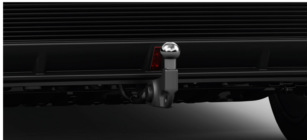
BARĂ DE REMORCARE RETRACTABILĂ, COMPLET ELECTRICĂ, INCLUSIV CABLAJ
